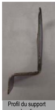
Fixer le support sur le longeron à l'aide de rivets et monter le connecteur.
